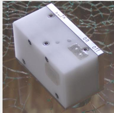
Gehäuse mit extrem starken Magneten
